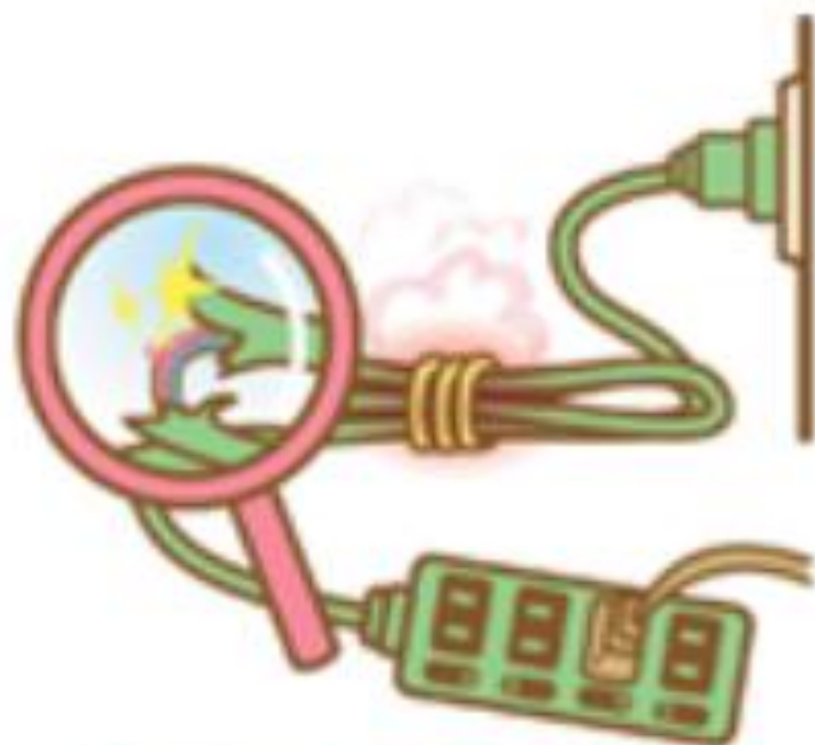
電線 不 摺綁折損
